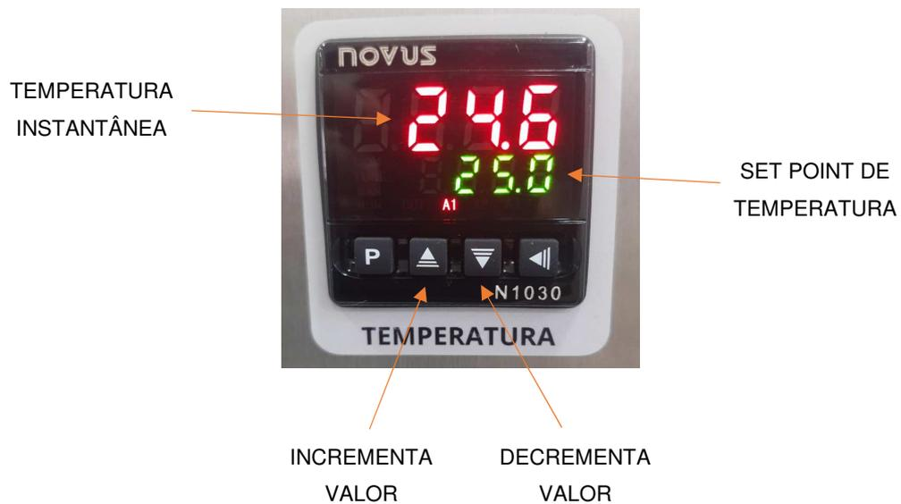
Figura 03 – Controlador de temperatura
